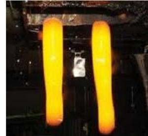
Este proceso de entrega, tan sencillo en concepto, tiene una importancia crítica en el proceso de formación ya que esos contactos y deformaciones que tiene la gota en movimiento van a condicionar enormemente el proceso de moldeo.
